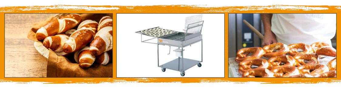
Das Handbelaugungsgerät Tauchboy steht für unkompliziertes, manuelles Belaugen kleiner Mengen. Durch das kompakte Design ist er sowohl in einer kleinen Produktion als auch direkt in der Filiale einsetzbar. Er ermöglicht eine tägliche Belaugung von bis zu 800 Teiglingen.
